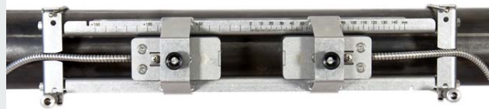
Meting met sensoren, gemonteerd met de draagbare Variofix VP
