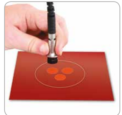
U kunt het geteld gemiddelde en de vaste groeps grootte gebruiken met alle Elcometer 456 sondes
