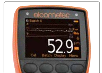
Trendgrafiek op LCD scherm toont de laatste 20 metingen
