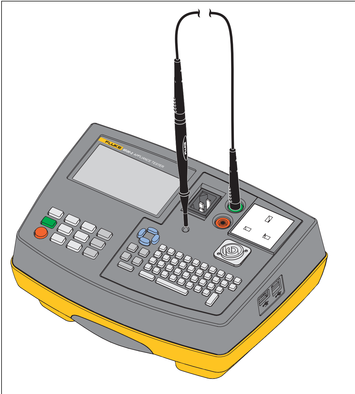
Afbeelding 1. Aansluitingen voor compensatie van de meetsnoerweerstand
